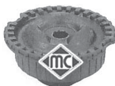
4337 soporte amortiguador delantero r.o. 4D0412377F
