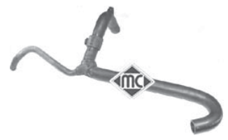
8788 mgto superior radiador 2.2dT hasta 11/'95 r.o.
