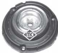
2930 soporte amortiguador delantero r.o. 5038.25
