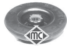
4153 tapa con tuerca amortiguador delantero r.o. 7700426450
