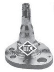
90048 buje rueda delantera 2.0-16v (Ø 127 mm) r.o. 1H0407613B
