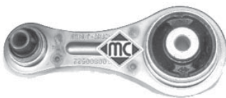
4165 tirante motor trasero 1.9 Diesel r.o. 7700426193-7700415088
