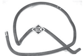
8604 mgto de botella a caja termostato 2.0 HDi r.o.
