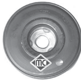
4666 Ø 152/155 mm - 7 canales 1.9 Diesel DTi Primastar r.o.
