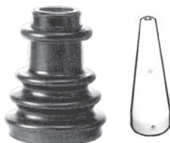
1274E kit rep. transm. l/rda para montar en cono (en neopreno especial de elasticidad 800%)
