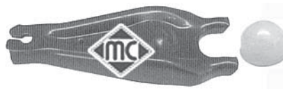
4297 horquilla embrague completa r.o. 7700725720
