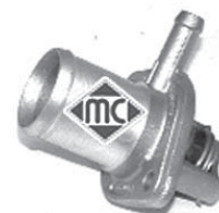
3156 tapa con termostato 1.2 hasta 6/98 r.o. 7700868980
