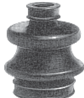
1066 kit fuelle transmisión trasera (Ø24-57 mm), r.o.
