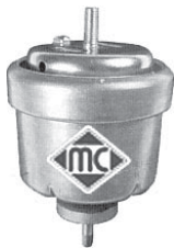
4386 silentbloc posterior puente trasero r.o. 5402631
