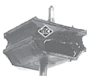
2694 soporte brazo trasero suspensión r.o. 5131.71
