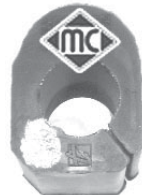
4167 goma central para barra establz. de Ø 24 mm r.o. 7700835929
