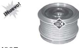
4997 Ø 61/55 mm, H=41 mm polea de alternador de rueda libre r.o.022903119A
