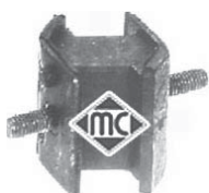
4348 soporte izquierdo cambio series 3 y 5 r.o. 24701138427
