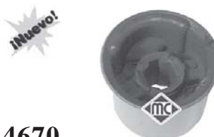
4670 silentbloc posterior trapecio delantero r.o. 6Q0407183A
