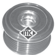
5007 Ø 61/55 mm - 6 canales VOLKSWAGEN (VAG) , de rueda libre Ibiza '02-Polo '02- (alternadores Valeo de 70A y 90A) r.o.
