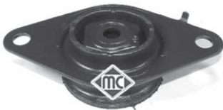
4091 soporte motor izqdo. 2.2dT y 16v hasta '98 y todos mods. desde '98, r.o. 7700818372
