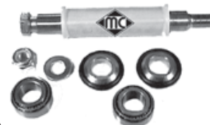
2920 kit reparación brazo suspensión trasero LANCIA r.o. no hay despiece
