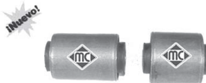
4940 juego silentblocs brazo inferior trasero r.o. montan en brazo 1064128
