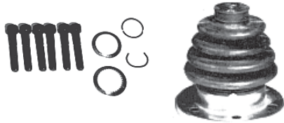
1632 kit rep. transmisión l/cambio 1.3-1.6 r.o. 171498201A
