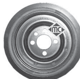
4494 Ø 143 mm - 6 canales motores 1.9SDi-1.9TDi Toledo 2-Leon-Golf 4-A3-Octavia-Ibiza Polo '03-Fabia, r.o. 038105243M-038105243L
