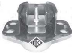
4028 hidráulico soporte motor derecho 1.4-1.9 D r.o. 7700434370
