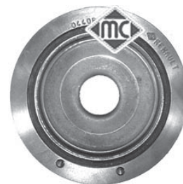
4736 Ø 123 mm - 6 canales motor F4R 2.0/16v Clio-II r.o. 8200386460
