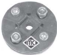
374 flector de dirección r.o. 95631286
