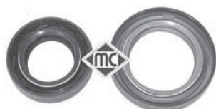
4564 Ø 30/47 y 40/58 mm juego retenes diferencial-transmisión r.o. 3121.44+3124.46
