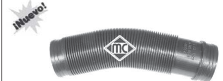
3718 tubo entrada aire a caudalímetro 1.9TDi r.o.6K0129684F
