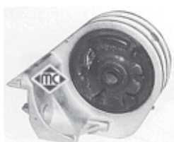
504 soporte motor lateral izquierdo 1.6 Diesel r.o. 7700770479
