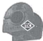
2631 Ø 16 mm goma barra estabiliz. delantera desde '91 a '94 r.o. 6543416
