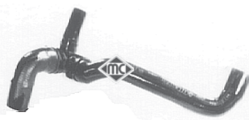
8394 mgtto de bomba a brida en culata 2.0 r.o.
