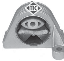
4567 soporte motor dcho. todos tipos desde '01 r.o.1839.A6-1802.56-1839.AT
