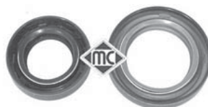
4564 Ø 30/47 y 40/58 mm juego retenes diferencial-transmisión r.o. 3124.46+3121.44
