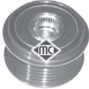
5007 Ø 61/55 mm, H=36 mm polea alternador de rueda libre r.o. 03D903119A
