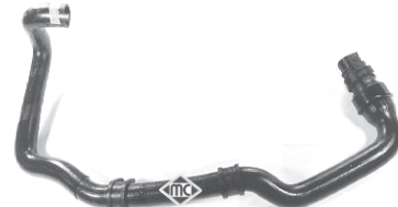
8265 mgto inferior radiador 1.4-1.6 motor TU r.o. 1351.J4
