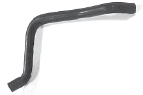
8160 mgto de decantador a tapón y cárter r.o. 1192.29-1192.30
