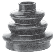
1577 kit fuelle transm. l/rueda Turbo i.e. hasta '88 r.o. 7578083
