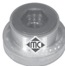
4948 6 canales RENAULT, desembragable motores de gasolina 1.4/16v - 1.6/16v r.o. 7700110616
