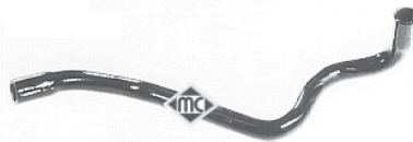
8378 mgto de tubo metálico a botella r.o.1H0121109-1H0121109A
