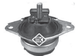
2992 hidráulico soporte motor trasero izquierdo desde '92 r.o. 1040404
