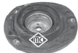
4080 soporte amortiguador delantero derecho todos salvo 1.1 r.o. 5038.40-5038.38-5038.34
