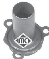
4796 altura 56,50 mm casquillo guía embrague con retén r.o. 2105.38
