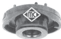
4029 soporte amortiguador delantero derecho desde '96, r.o. 7700832420-6025305979
