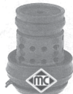
2685 soporte motor delantero r.o. 1H0199609E/F
