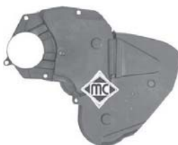
3696 juego tapas correa distribución 1.5D (motor TUD5), r.o. 0320.K6+0320.P5
