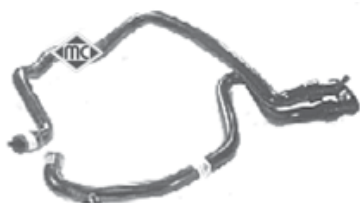
8301 mgto doble de calefactor 1.8-2.0 r.o. 1351.Q1
